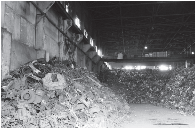
一度に製鋼作業をするために貯められたスクラップ置場
